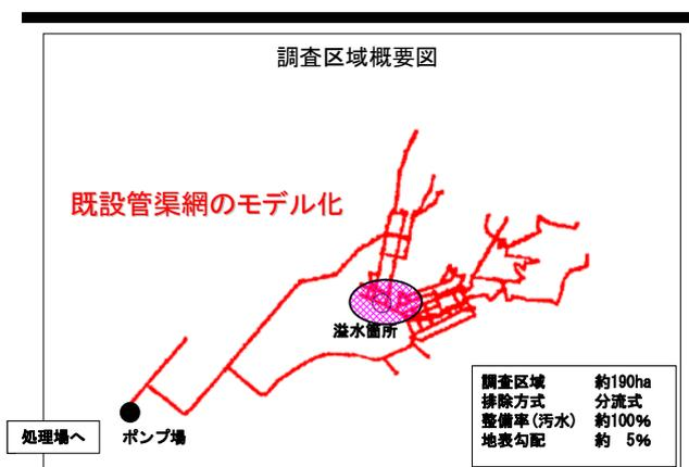
図 3-11 管きょモデル化状況図
