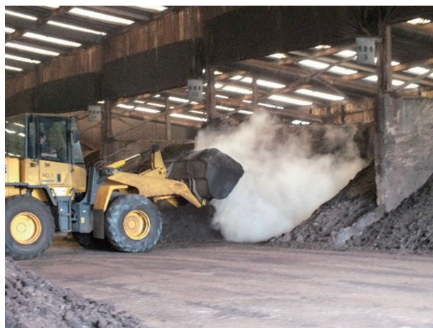
写真-2 ホイローダーでの切り返し作業風景
