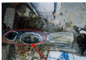
外面腐食により貫通した管の例
