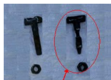
腐食した連結ボルトの例
