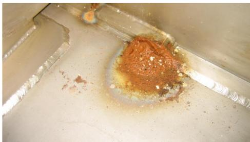
図-7 ステンレスタンク内腐食状況
