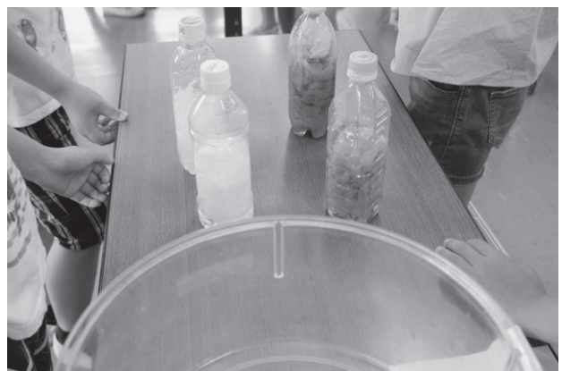
写真-9 妖怪実験室(簡易溶解実験)の様子 (別々のペットボトルに、ティッシュと色付きトイレトペーパーを水と一緒に入れ、シェイク!溶解状況を観察します)
