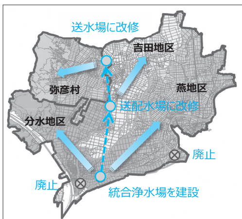
図-3 浄水場施設再構築事業のイメージ
