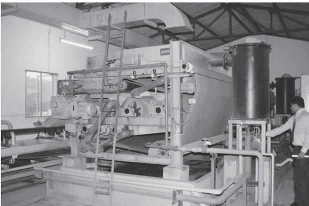
写真-4 汚泥脱水機（引き抜きなし・なんと未使用）
