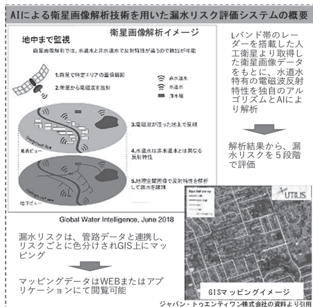
図-4 人工衛星による漏水診断のイメージ
