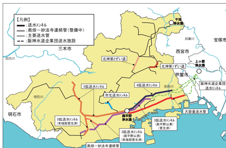
図－3 神戸水道送水幹線の概況
