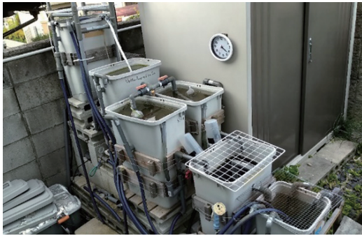
写真-2 自宅で製作した小型装置 緩速ろ過が10m/日、2槽で2.7m 3 /日の浄水能力。
