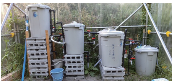
写真-3 群馬県桐生市星野管工(株)のデモ装置 左から原水槽、上向流粗ろ過槽、緩速ろ過槽、浄水槽。 緩速ろ過が10m/日、2槽で3.9m 3 /日の浄水能力。
