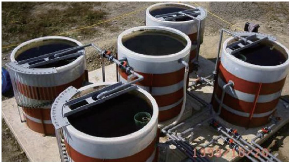
写真-1 1999年に製作した検証用実験装置 水槽のφ1.4mの上向流粗ろ過1槽と緩速ろ過4槽。10m/日で15nl/日/槽。4槽で約60ml/日。
