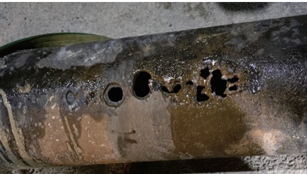
写真－2 漏水箇所 (1967竣工DCIP φ350mm)
