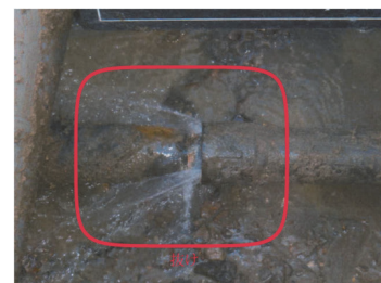
写真－11 鋼管継手の破損 (新潟市水道局提供)
