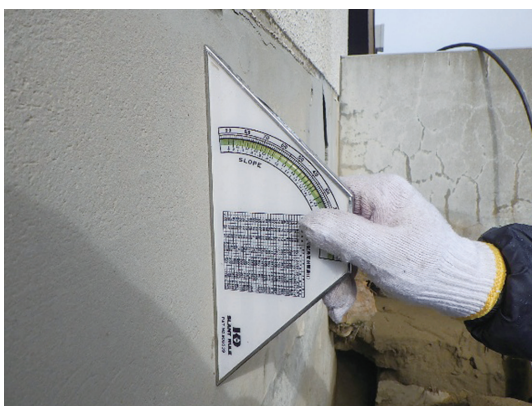
写真-5 塩素混和池棟の傾斜測定状況
