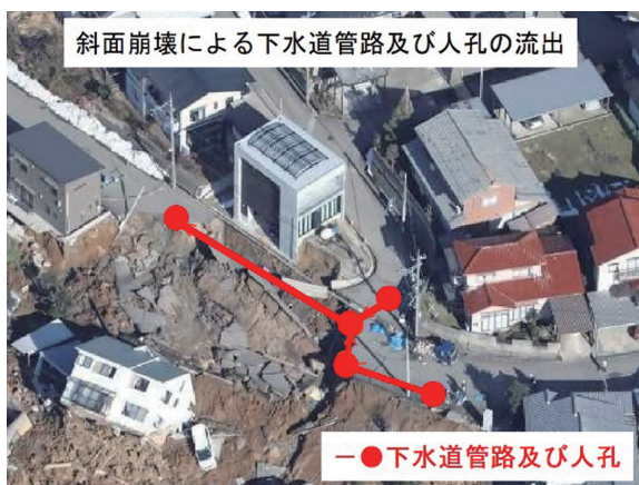
写真－４ 下水道管路の被害状況（管路及び人孔流出）
