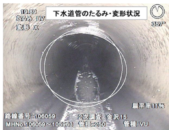
写真－２ 下水道管路の被害状況（たるみ・変形）
