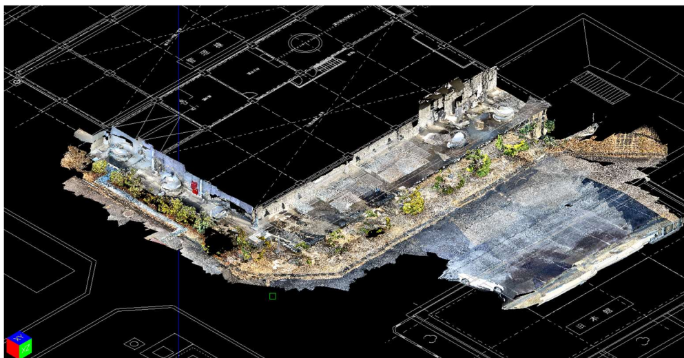
図 3 点群データ・現況平面図の重ね合わせ画面（V-nasClair）
