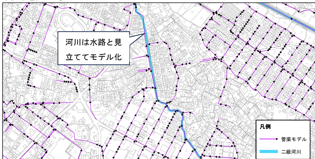
図-2 イ地区における管路モデル作成例
